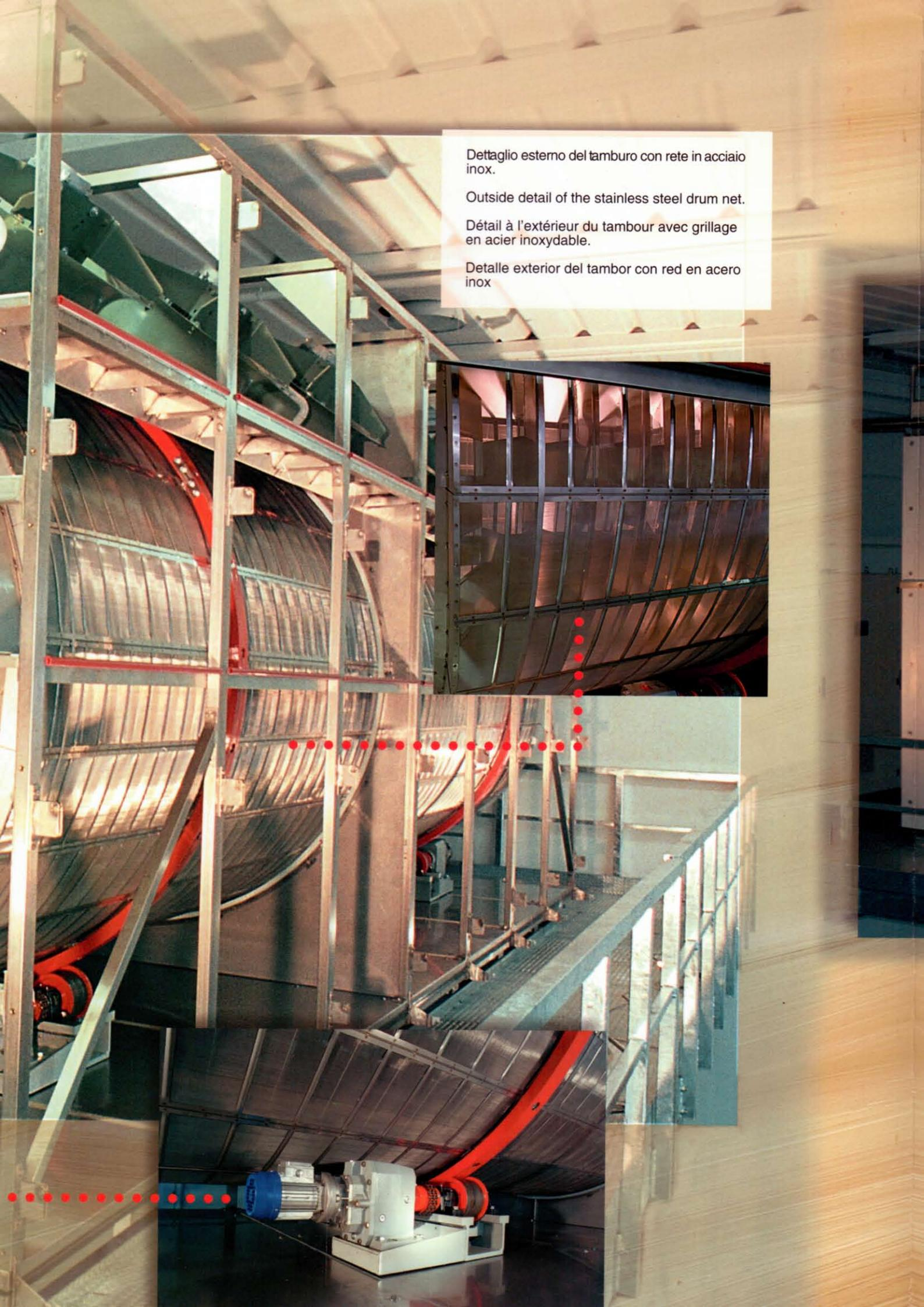
Dettaglio esterno del tamburo con rete in acciaio inox.
