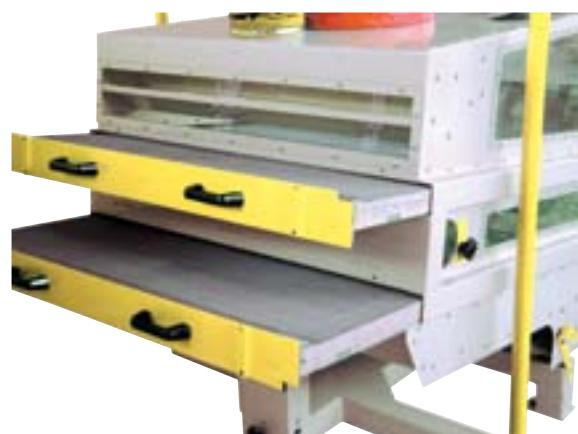
Las tararas radiales se utilizan para separar polvo, impurezas livianas, granos quebrados de cereales no procesados. El sistema tiene la ventaja de reutilizar la mayor parte de su aire sin agotarlo y por ellos no hay necesidad de un sistema central de aspiración o filtro especial por los que se reduce el consumo de energía.
