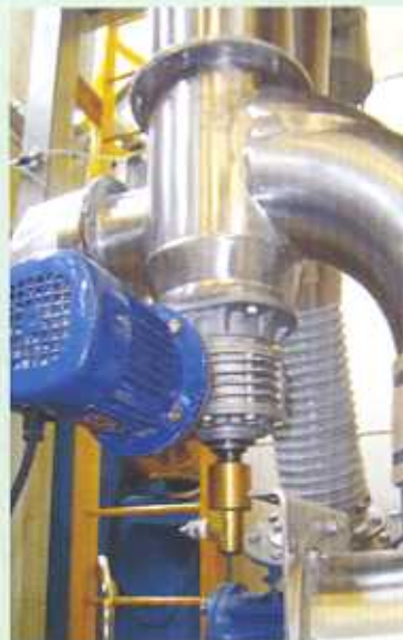
Sistema per aumento della resa del separatore per determinati materiali Increasing output system for the classifier for some materials
